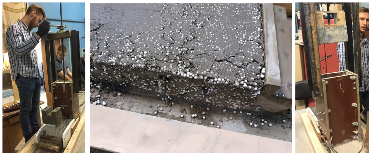
Рис.2. Лабораторные испытания печатающей головки.
