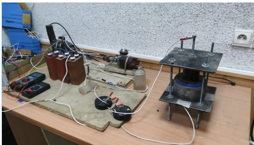
Рис. 1 Принципиальная схема установки для активации цементной суспензии
