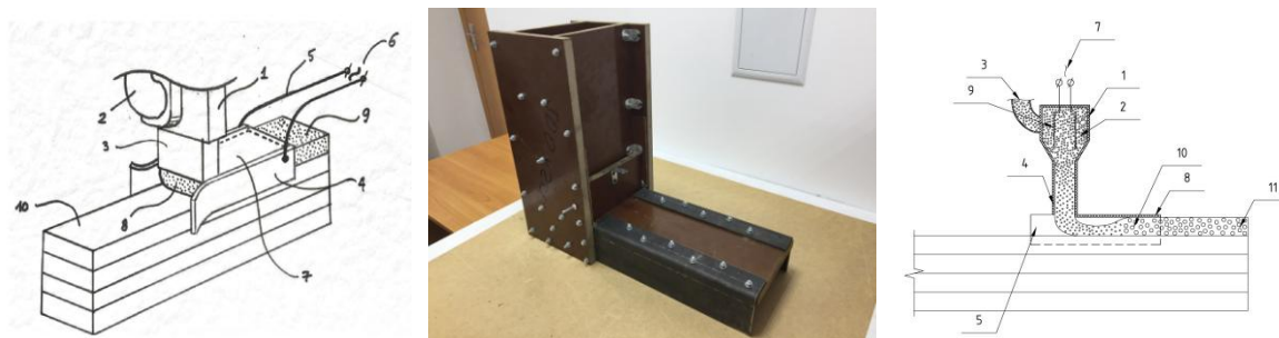
Рис 1. Принципиальное решение и общий вид печатающей головки 3D-принтера для форсированного разогрева и экструдирования полистиролбетонной смеси.
